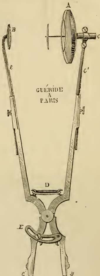
Fig. 91. — Tambour monté sur un compas. (Bert.)
