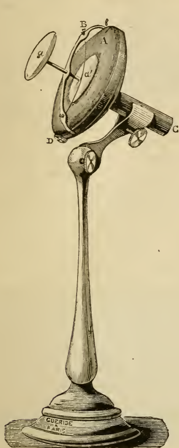
Fig. 90. — Tambour pour recueillir les mouvements du thorax. (Bert.)
