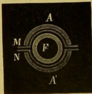
Querschnitt der das elastische Rohr zusammensetzenden Gummiplatten M, N , sammt Glasrohr F und Metallkapsel A, A' , entsprechend dem rechten Ende der in Fig. 61 dargestellten Vorrichtung.
