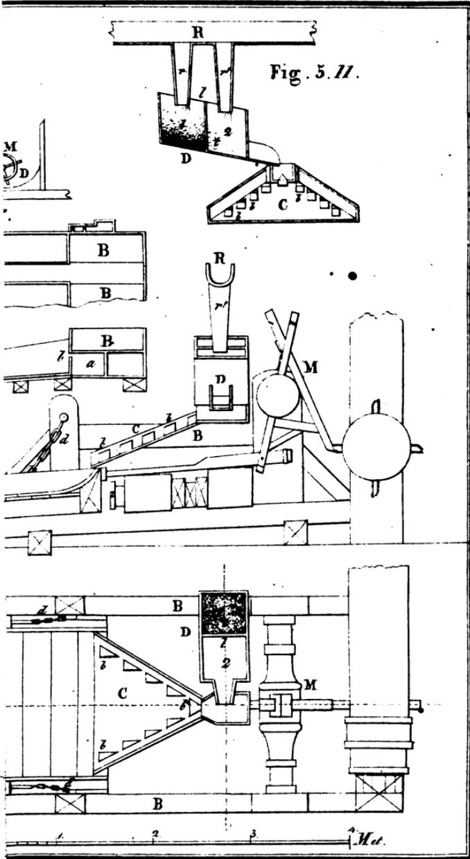
raison de la table varie de 2 à 15 centimètres. L'eau y est répandue tantôt en filets déliés, tantôt à plein tuyau, en sorte qu'il y coule jusqu'à deux pieds cubes d'eau par minute. Le nombre des secousses qu'elle reçoit varie de 15 à 36 par minute. Elle s'écarte de sa position primitive, tantôt de 2 centimètres, tantôt de 20. Le gros sable exige en général moins d'eau et moins d'inclinaison dans la table que le sable fin et visqueux.
