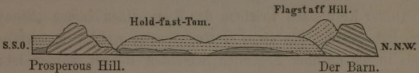
Fig. 9. Die doppelten Linien stellen die basaltischen Schichten, die einfachen die basalen submarinen Schichten, die punktirten die obern feldspathigen Schichten dar.
