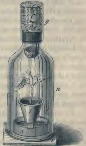
Fig. 28. Apparat zu Culturversuchen in kohlenstofffreier Luft. Die Glasglocke n ist luftdicht der abgeschliffenen Glasplatte r angepasst. Das dem Tubulus angepasste Glasrohr g enthält mit Kalilauge getränkte Bimsteinstücke, um die in die Glocke tretende Luft von Kohlensäure zu befreien. Die in der Porzellanschale s befindliche Kalilauge hat ferner die durch Athmung der Pflanze und aus dem Boden des Topfes f entstehende Kohlensäure zu absorbieren. Die Porzellanschale g hat einmal eventuell aus g abtropfende Kalilauge aufzufangen und kann zur Aufnahme von Chlorcalcium dienen, wenn die Luft in der Glocke nicht dampfgesättigt sein soll.
